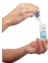
Use o ESTOJO DE ANÁLISES GENCO – DC para análise da dureza cálcica
